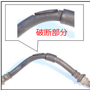
<ブレーキホースの破断事例>
